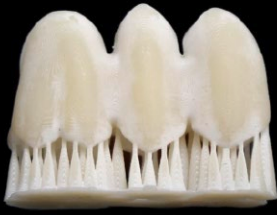
19 Armature de facette SMART en VarseoSmileCrownPlus, fabriquée par impression 3D.
