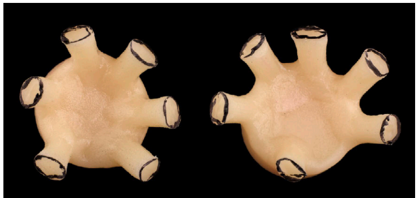
55 Les cônes de pressée détachés révèlent la forme ovale de nos modèles en cire.
