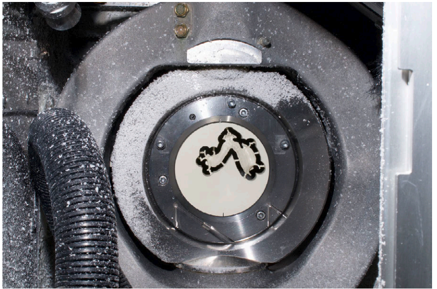
7 L'usinage sur cinq axes des bras de l'agrafe est impératif
