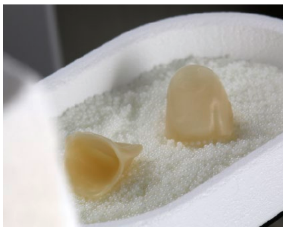
► 11 Seulement 45 minutes plus tard : armatures de dents antérieures après le frittage rapide dans le lit de frittage
