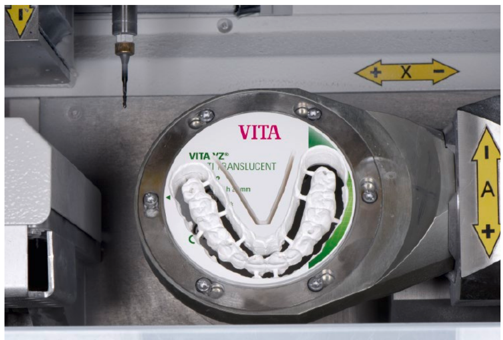
Le recouvrement en VITA YZ MULTI TRANSLUCENT fabriqué en CFAO dans l'unité de fraisage
