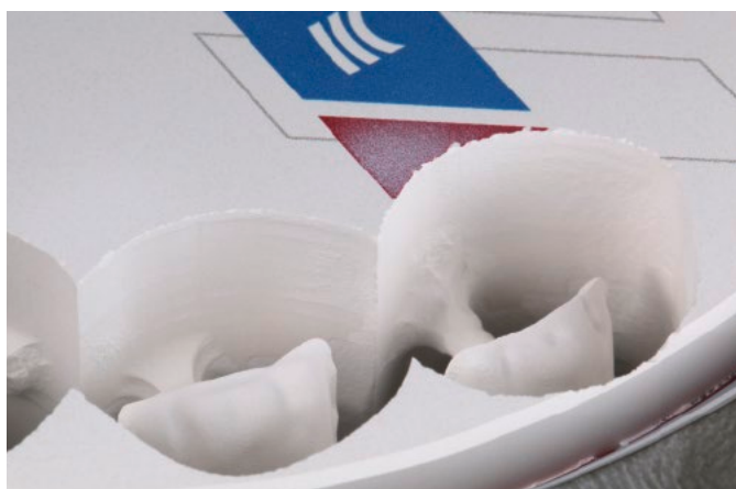
► 8a et ► 8b Fraisage des armatures (Zolid Bion) avec une grande stabilité des bords et une grande précision des détails
