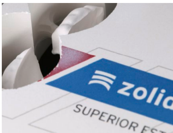
► 8a et ► 8b Fraisage des armatures (Zolid Bion) avec une grande stabilité des bords et une grande précision des détails
