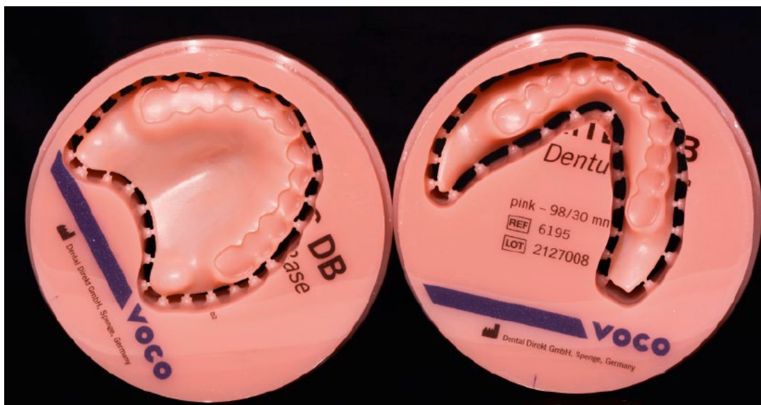
➤ 19 Bases de prothèses fraisées reliées au rond par des connecteurs
