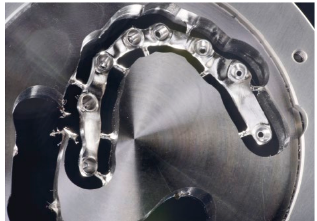
Le chevalet a été fabriqué soustractivement à partir d'un rond en titane.
