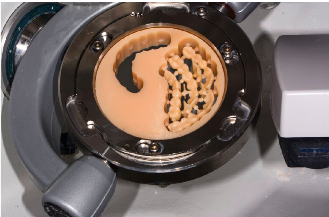
➤ 18 Segments de dents après le fraisage dans le rond avec porte-pièce.
