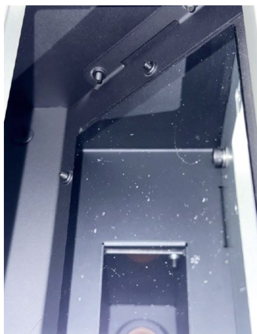
► Comme pour la lentille, l'encrassement du miroir peut réduire les performances de l'imprimante 3D.
