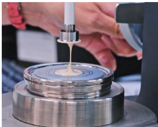
➤ 9 Mesure de la viscosité de la pâte
