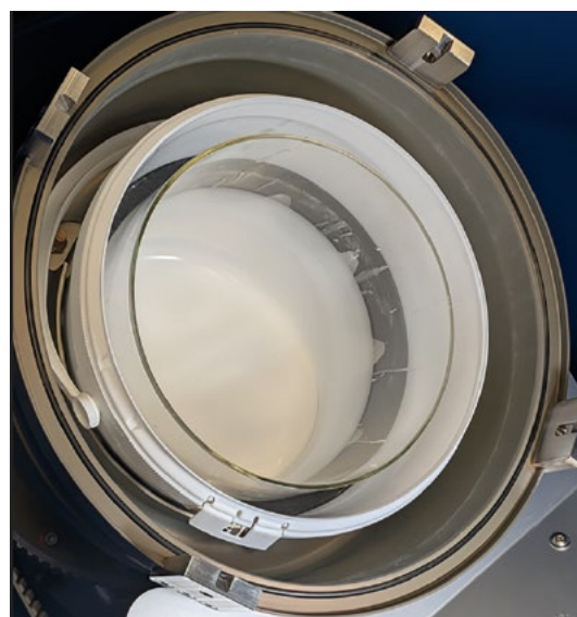
► 8 Pâte en sortie du centrifugeur
