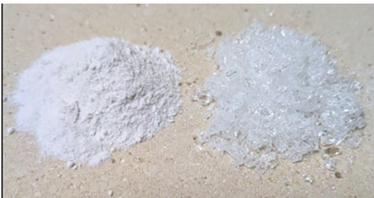
➤ 3 Mélange des matières premières avant fusion (à gauche) et verre après fusion (à droite)
